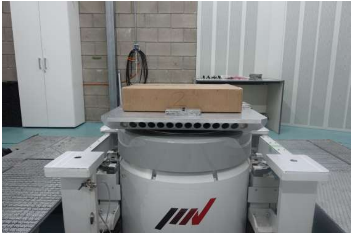
Ensayos de Vibraciones Verticales – Fuente: AIDIMME
