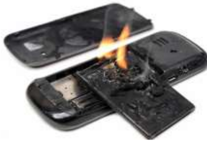
Reacción runaway en una batería de iones de litio.
