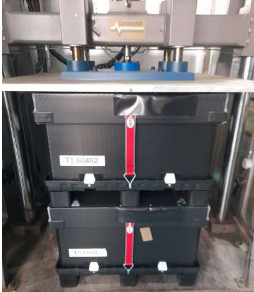
Ensayo de Apilado – Fuente: AIDIMME
