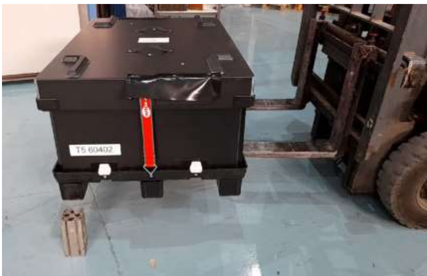
Ensayo de Levantamiento por debajo– Fuente: AIDIMME
