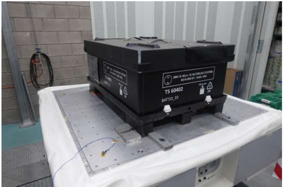
Embalaje cedido por: ALTOPLAST para hacer ensayos de Vibraciones y Choques – Fuente: AIDIMME
