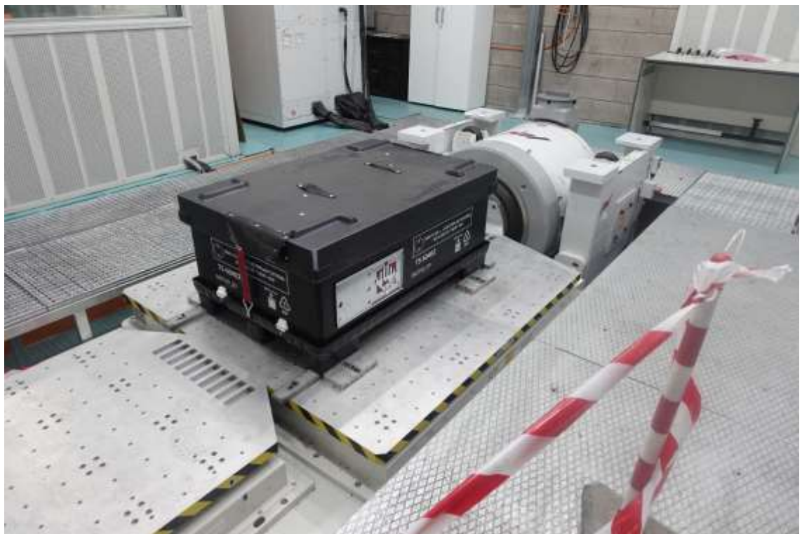
Ensayos de Vibraciones Horizontales – Fuente: AIDIMME
